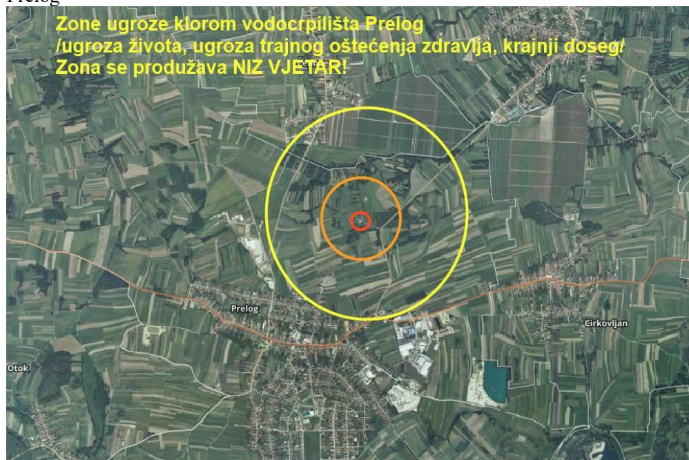
Slika 6: Iznimno mogući slučaj ispuštanja klora raspadom boce od 50kg s klorom, vodocrpilište Prelog
